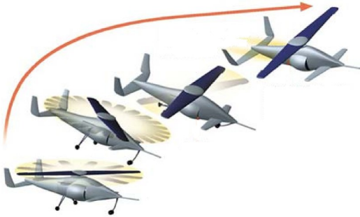
图1 旋转机翼式VTOL模态转换飞行过程
